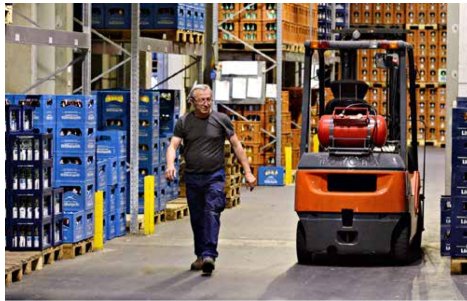
Gasstapler in der Logistikhalle
